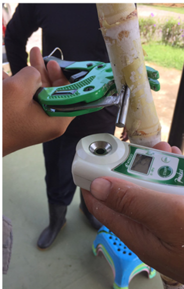
รูปที่ 4 การเจาะลำอ้อยเพื่อ การตรวจวัดค่าปริกซ์สำหรับงานวิจัย
